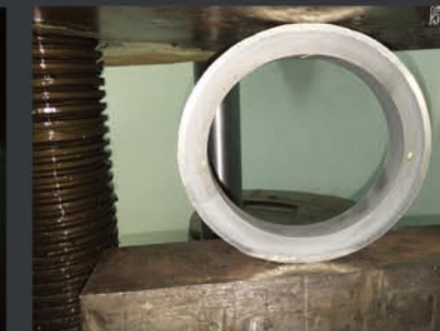
DRILL-GUARD Ti焊丝在26,647磅(12,086公斤) 力下持续作用于1"(2.5cm)环形套上，在屈服变 形前无任何剥落、开裂和脱层。 (德克萨斯休斯顿Accu-Test实验室测试)
