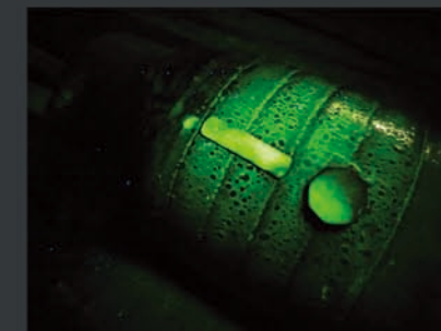
DRILL-GUARD Nb进行湿磁性能检测 (德克萨斯休斯顿Accu-Test实验室测试)
